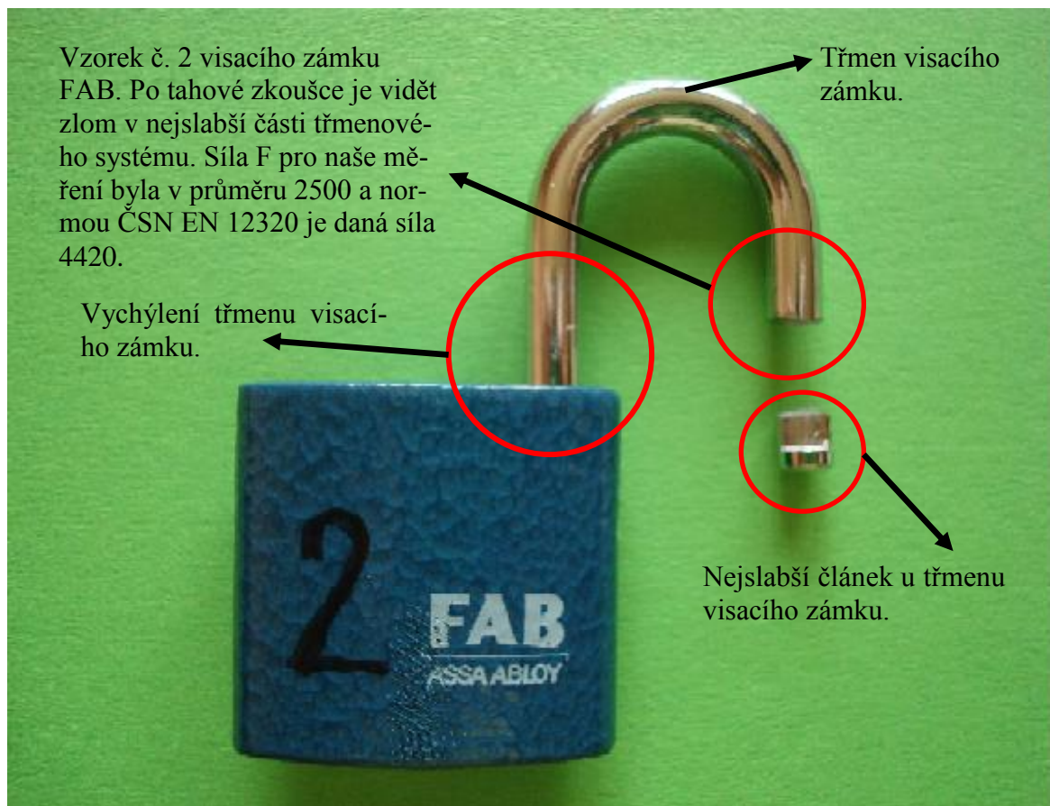
Obr. 22. Vzorek č. 2 po tahové zkoušce
