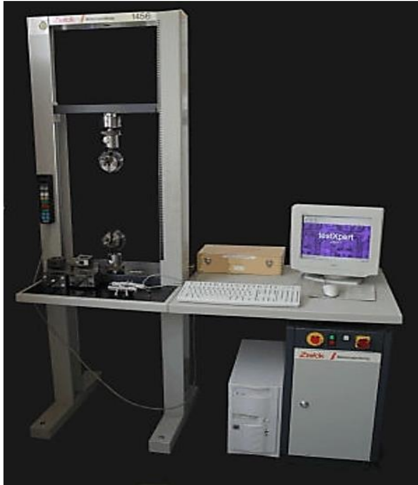
Obr. 17. Zkušební systém ZWICK 1456[23]
