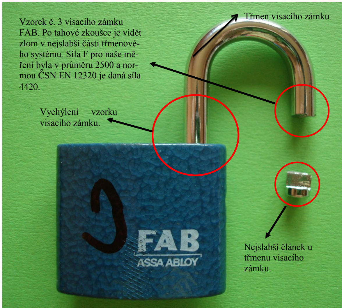
Obr. 23. Vzorek č. 3 po tahové zkoušce
