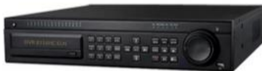
Obrázek 21: Digitální videorekordér s možností vzdáleného přístupu. [23]
