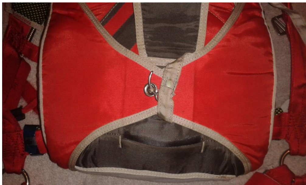
Obrázek 18 Správně zastrčený uzavírací trn [14]
