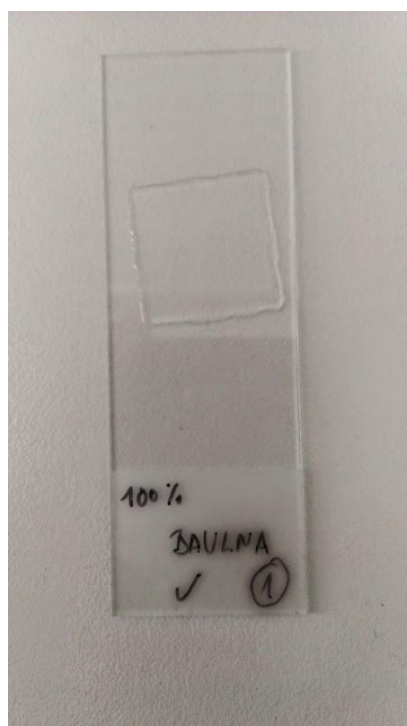
Obr. 8: Podložní sklíčko se vzorkem textilního vlákna
