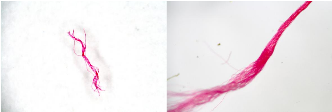
Obr. 48: Polyester před použitím UV světla (nalevo) a po použití UV světla (napravo)- zvětšení 50 x
