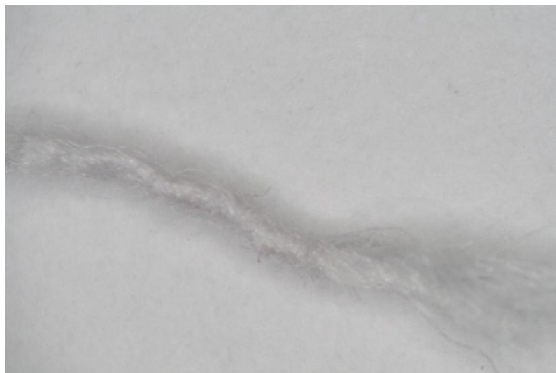
Obr. 47: Bavlněné vlákno po 14 denním působení UV záření - zvětšení 50 x
