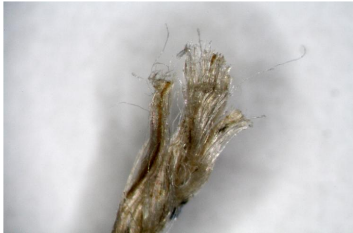
Obr. 26: Lněná nit - zvětšení 50 x
