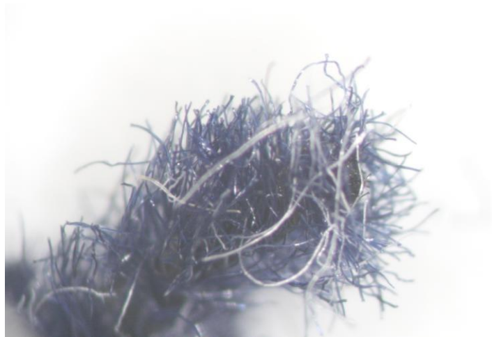
Obr. 15: Akrylová příze - zvětšení 50 x
