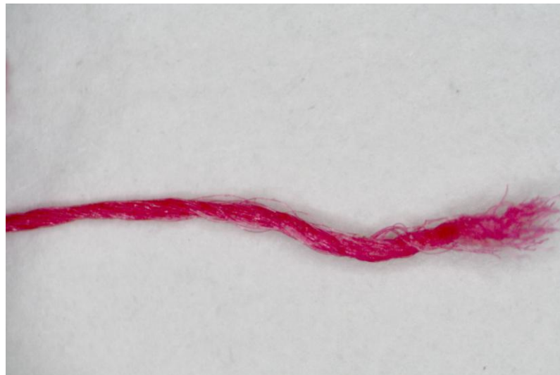
Obr. 49: Polyesterové vlákno po 14 denním působení UV zá- ření - zvětšení 50 x
