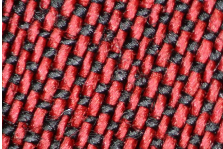
Obr. 35: Viskóza - struktura textilního materiálu - zvětšení 50 x
