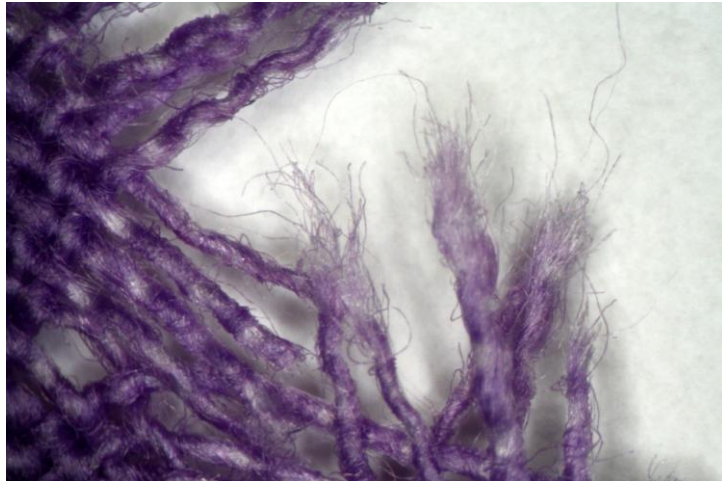
Obr. 19: Bavlna - roztržený textilní materiál- zvětšení 50 x
