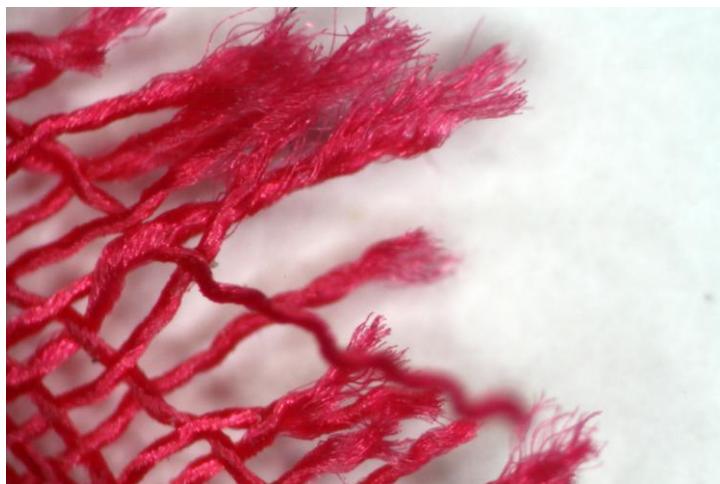
Obr. 30: Polyester - roztržený textilní materiál - zvětšení 50 x
