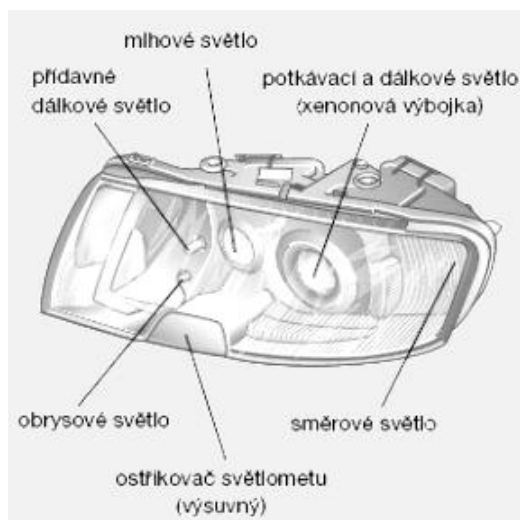
Obrázek 17: Konstrukce světlometu [17]
