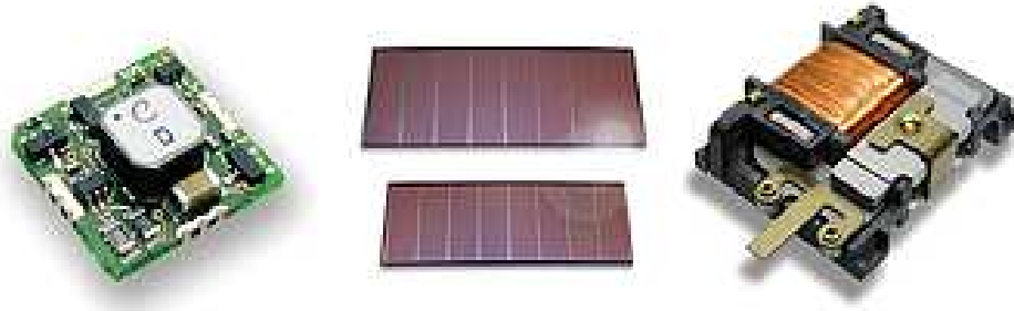
Obrázek 6 Tepelný konvertor, solární panel a EnOcean konvertor pohybu[3]
