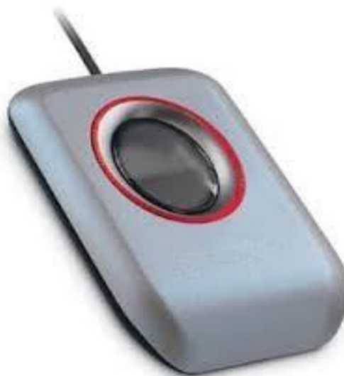
Obrázok 13 Prvok pre snímanie odtlačku prsta [23]
