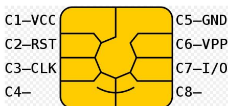
Obr. 7: Struktura kontaktního čipu [13]
