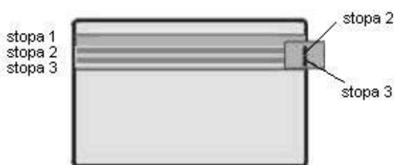
Obr. 4: Struktura stop na magnetickém pásku [8]
