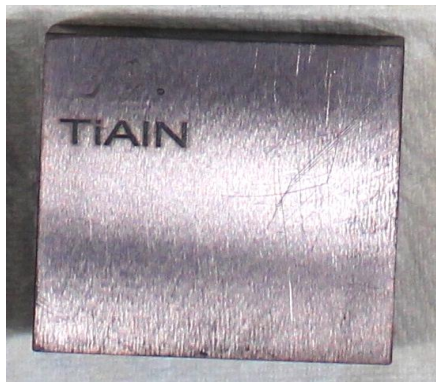
Obr. 20. Povlakovaný měřený vzorek 40mm x 40mm x 10mm
