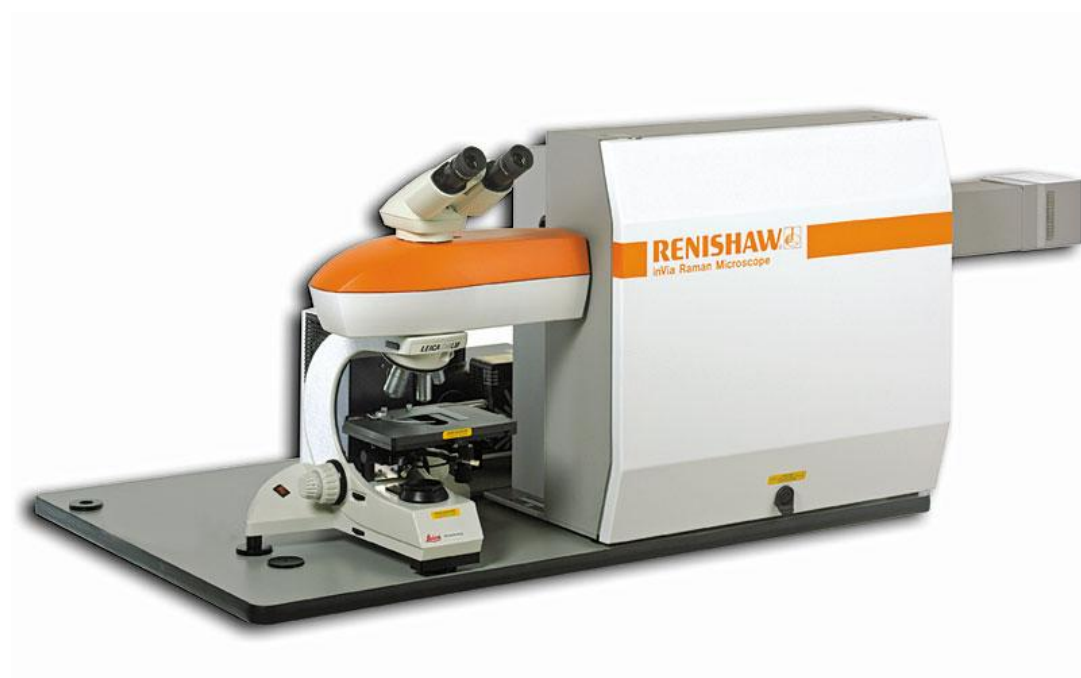
Obr. 24 Ramanov mikroskop Renishaw inVia Basis [14]
