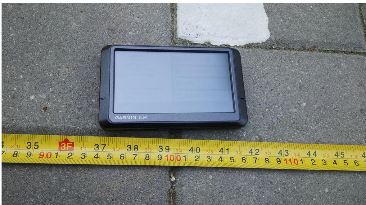
Obr. 9 Měření souřadnice ve vzdálenosti 100 cm od referenčního bodu na Sever.
