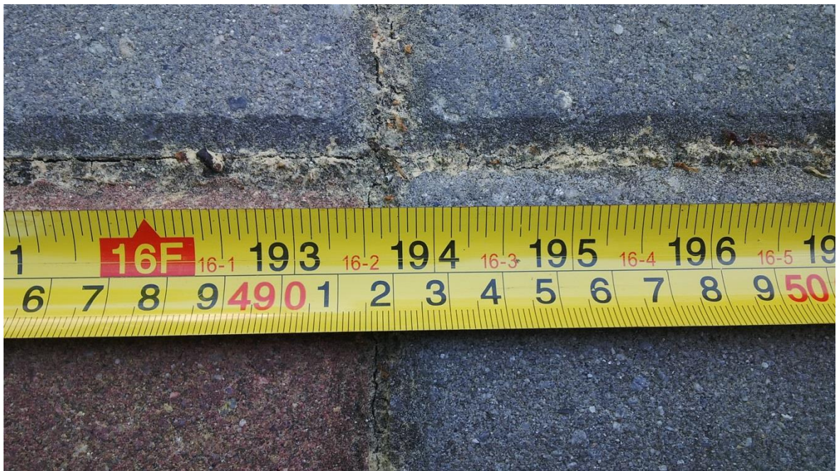
Obr. 7 Zaměřování referenčního bodu od patníku – naměřená vzdálenost
