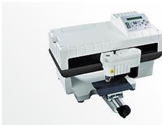
Obr. 9 CNC gravírka Gravograph IS200 - malá CNC gravírka vhodná i pro náročnější aplikace [13]
