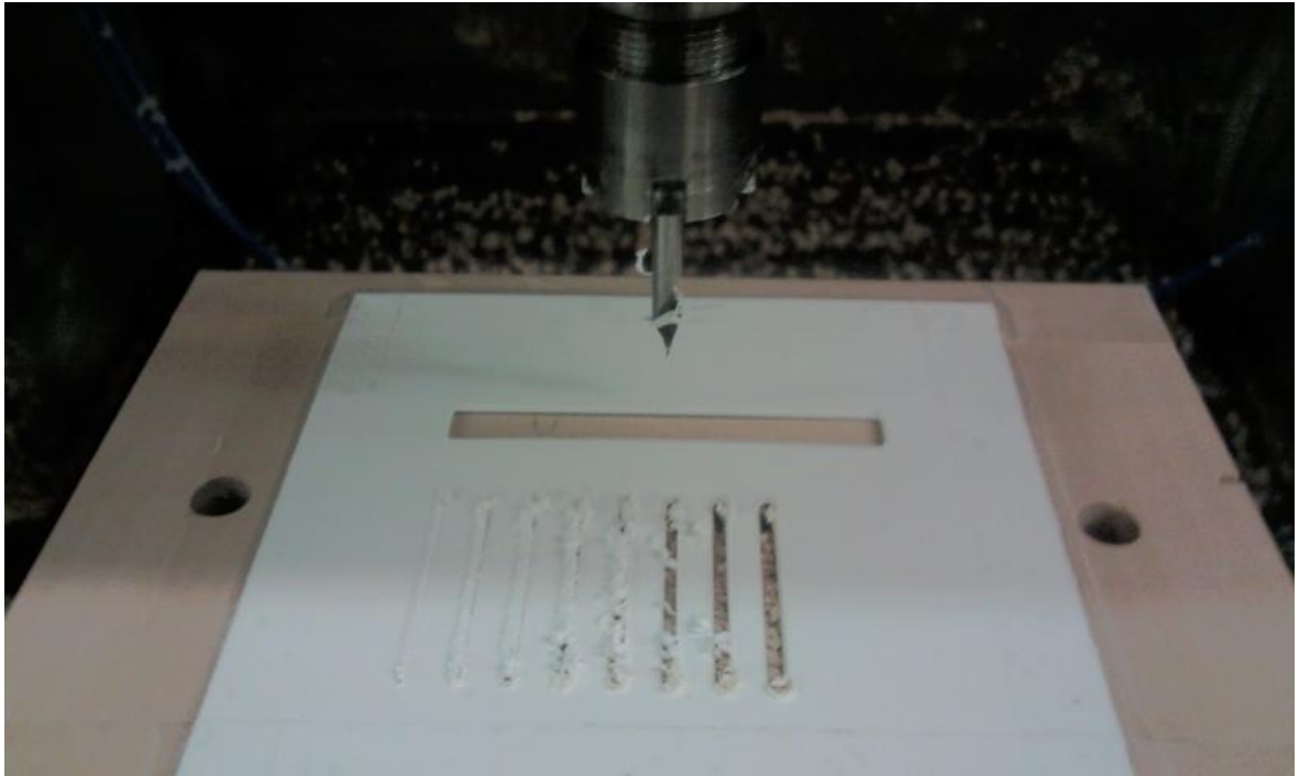
Obr. 27 Výroba vzorku na šířku drážek
