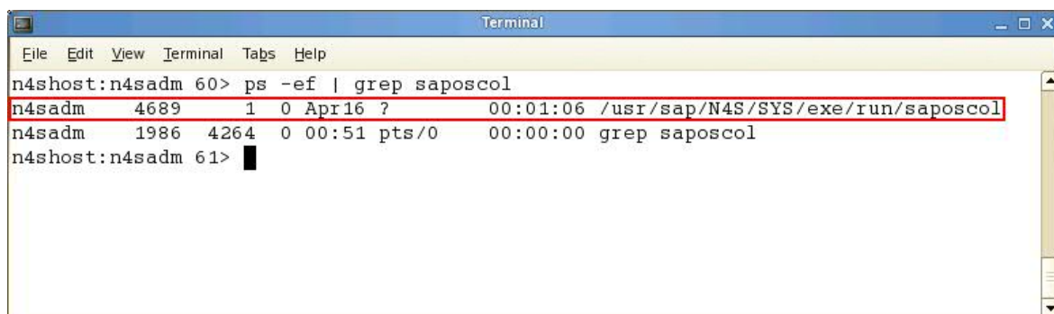
Obr. 10. Proces kolektoru na OS
