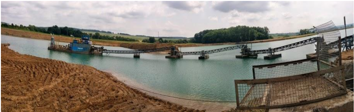
Obrázek 4 Soustava plovoucích dopravních pásů ve Spytihněvi
