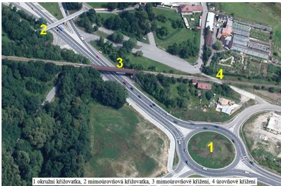
Obrázek 12 Základní typy provedení křižovatek a křížení v praxi [12]
