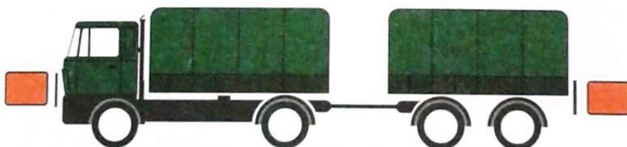
Způsob označení vozidla s přívěsem při přepravě nebezpečných věcí v kusech
