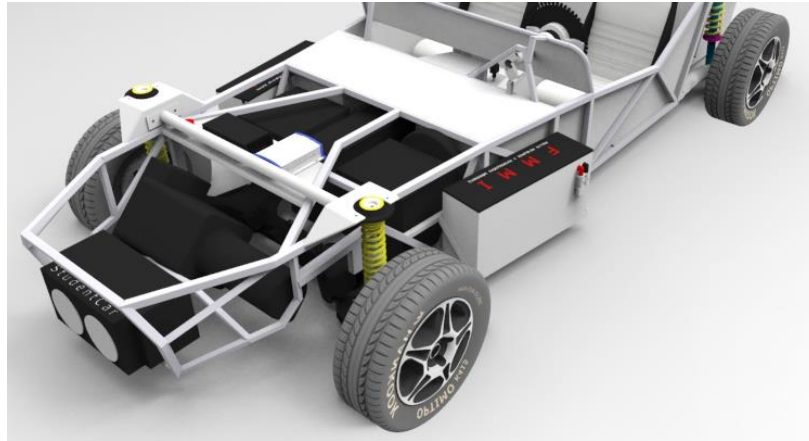
Obr. 26 Detail umístění postranních baterií
