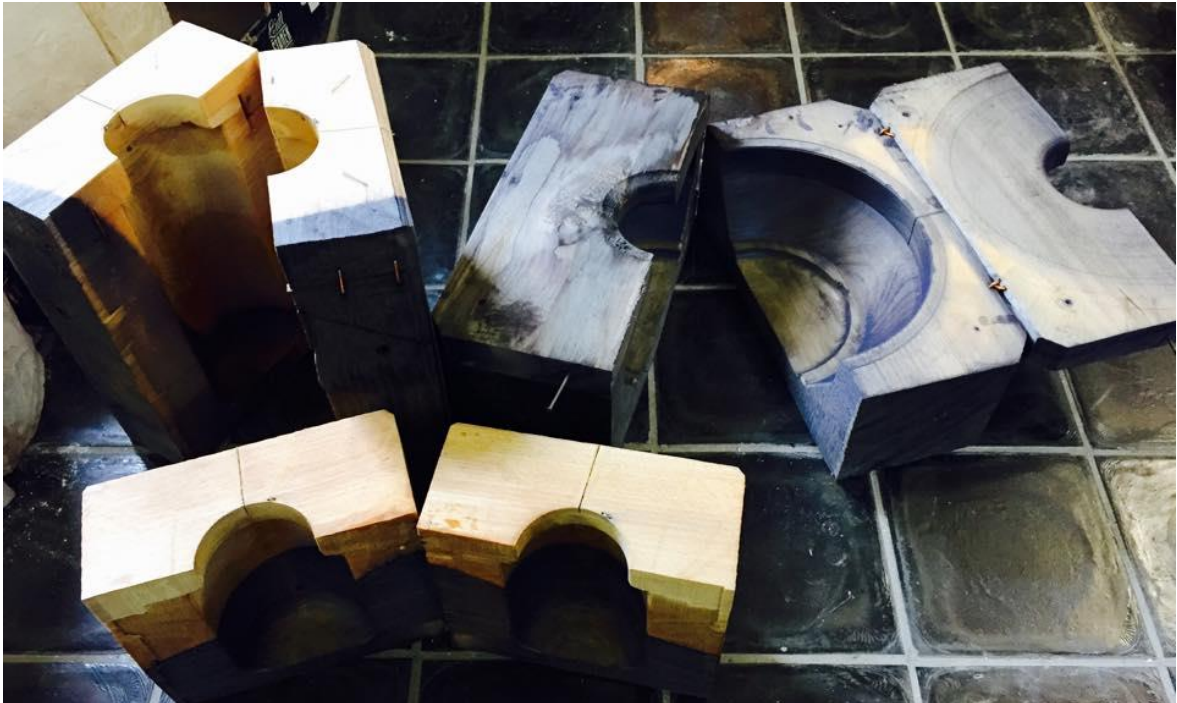
Obr. 49 zhotovené formy na foukání skla
