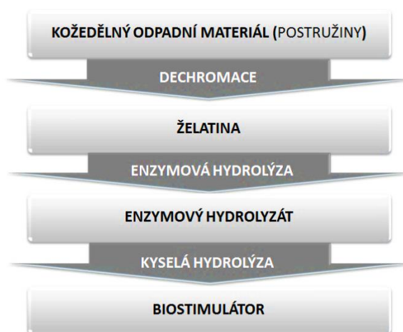
Obr. 1 Hydrolyzační proces zpracování kožedělných odpadů
