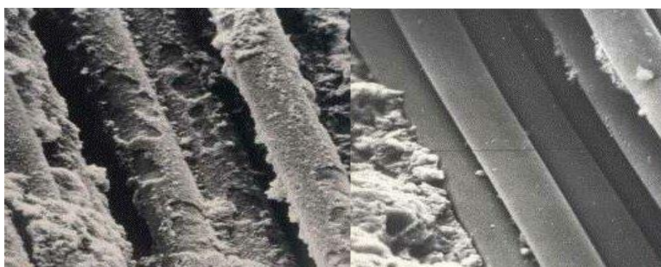
Obr. č. 15 : Vlevo vlákno typu E po několika týdnech v betonu , vpravo vlákno Cem-FIL po několika letech expozice v betonu.
