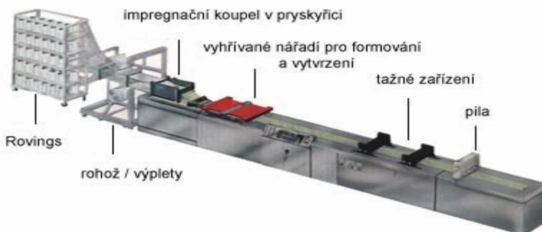
Obr. č. 11 : Výrobní linka pro pultruzní tažení
