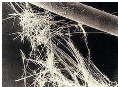
Obr. č.14 : Porovnání azbestových a skleněných vláken Cem-FIL
