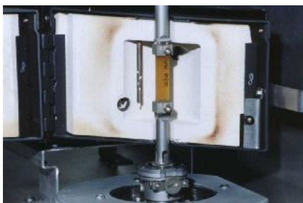
Obr. 25. Zkušební vzorek je připraven k měření DMA v tepelné komoře, která se uzavře (35)
