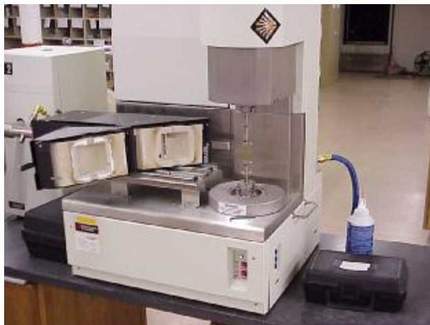
Obr. 24. Ukázka zařízení pro měření DMA (RDA III) – vzorek je upnutý v čelistech (35)
