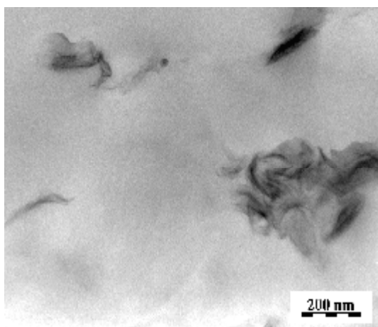
Obr. 38. TEM vzorku na bázi PE s 3% Nanofilu 3000
