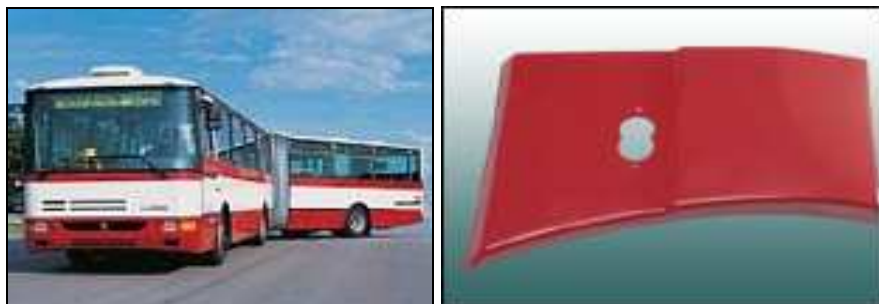
Obr. 10. Vnější bok City Busu vyroben metodou RFI
