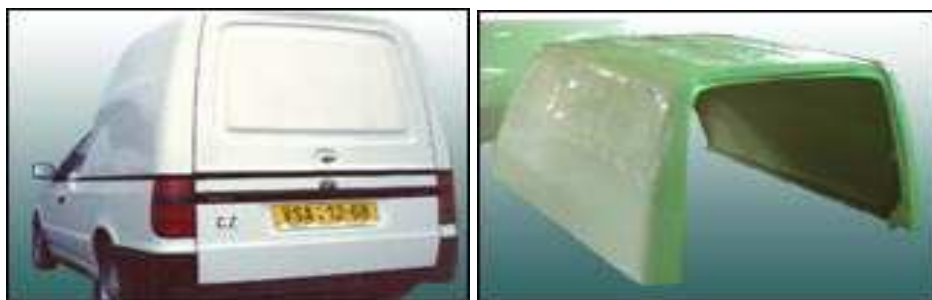
Obr. 9. Sklolaminátový spoiler pro Škodu pick-up vyrobený metodou RFI
