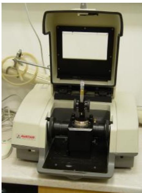
Obr. 7. FTIR spektrometr: AVATAR – 320 firmy Nicolet
