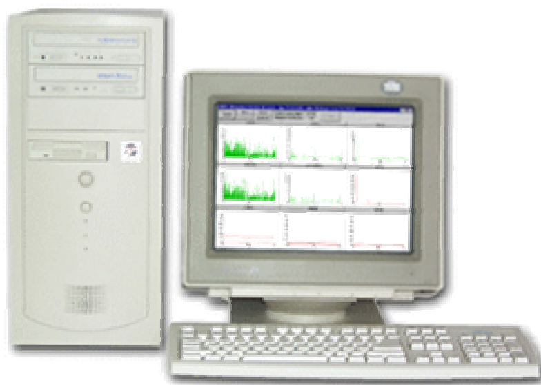
Obr. 16. Digitální tester QC-CDD40
