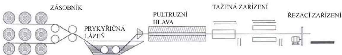
Obr. 4. Schéma pultruzní linky
