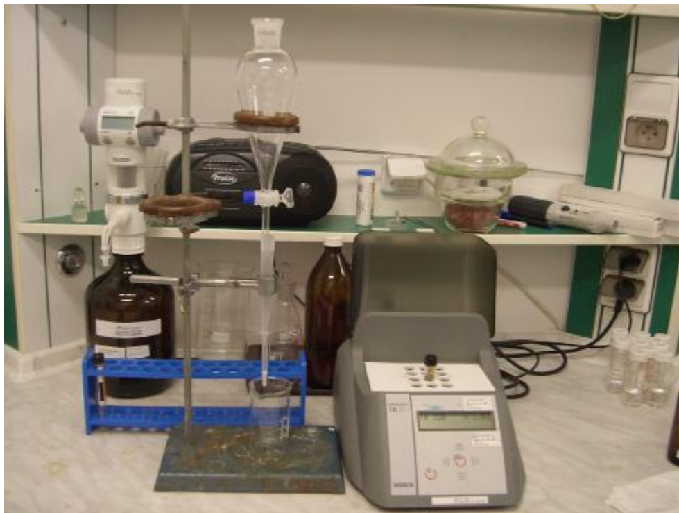
Foto 1: Aparatura a termoreaktor TR Spectroquant s nastavitelnou teplotou
