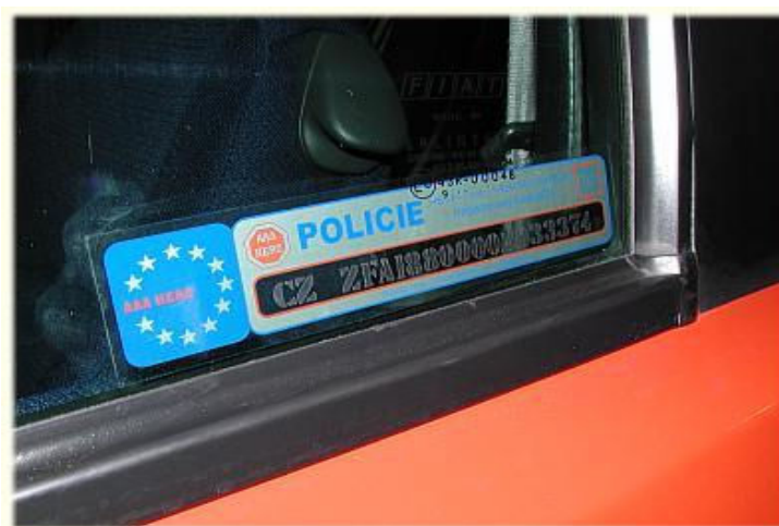
Obr. 4. Vozidlo označené výrobným číslom karosérie VIN
