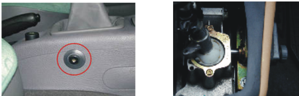
Obr.3. Automobil zabezpečený mechanickým zámkom radiacej páky
