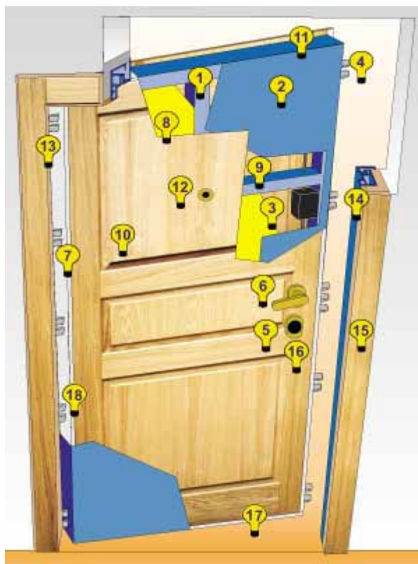
Obr. 5 Bezpečnostní dveře (4. bezp.třída)
