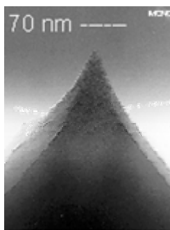
Obr. 2. Skenovací hrot řádkovacího tunelového mikroskopu [4]
