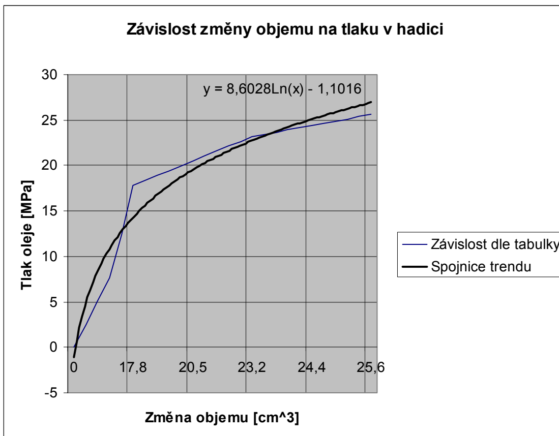
obrázek 33 závislost změny objemu hydraulické hadice
