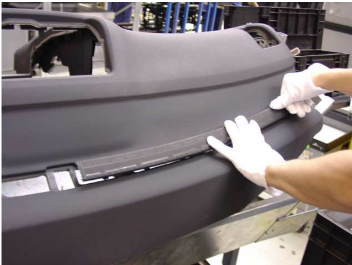
Obr.19. Montáž kompletního dílu mřížky rozmrazování do přístrojové desky [vlastní zdroj]
