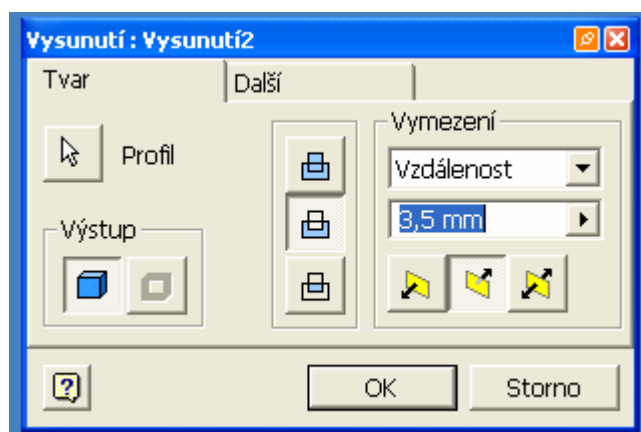
Obr. 35. Dialogové okno pro tvorbu drážky pera
