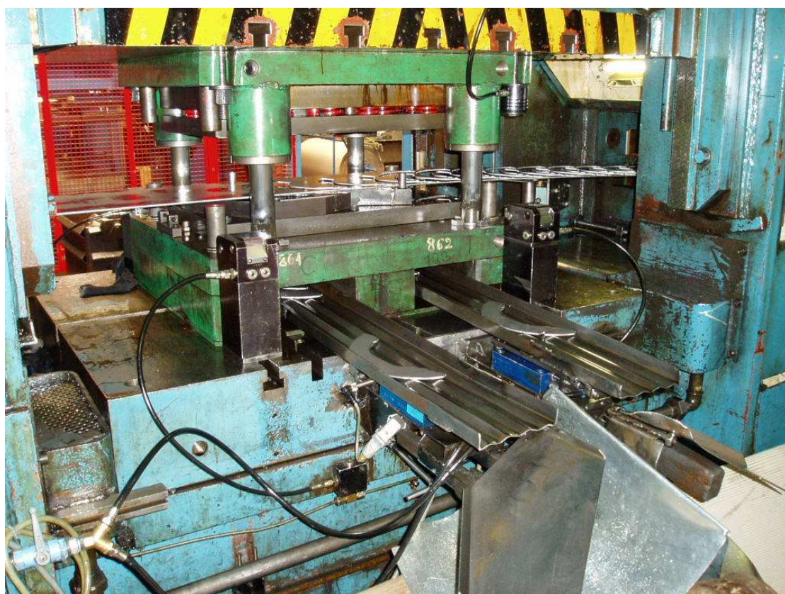
Obr. 28. Stříhání základního profilu
