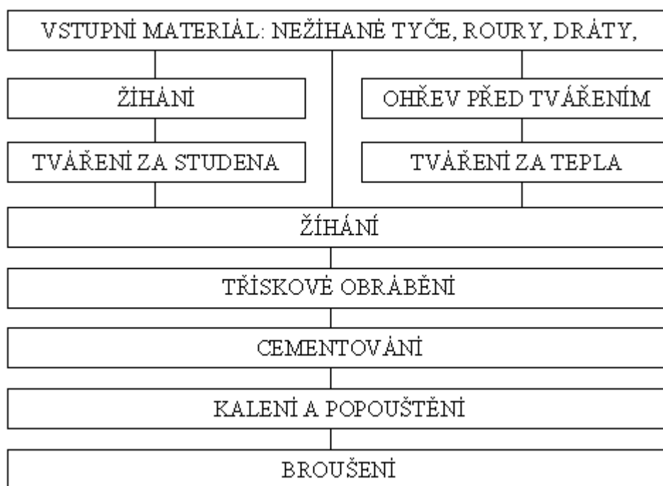
Obr. 24. Schéma zařazení chemicko-tepelného zpracování při výrobě dílů ložisek
