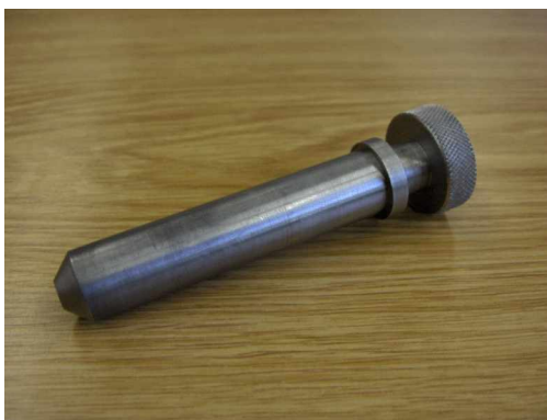
Obr. 28. Navržený spojovací kolík
