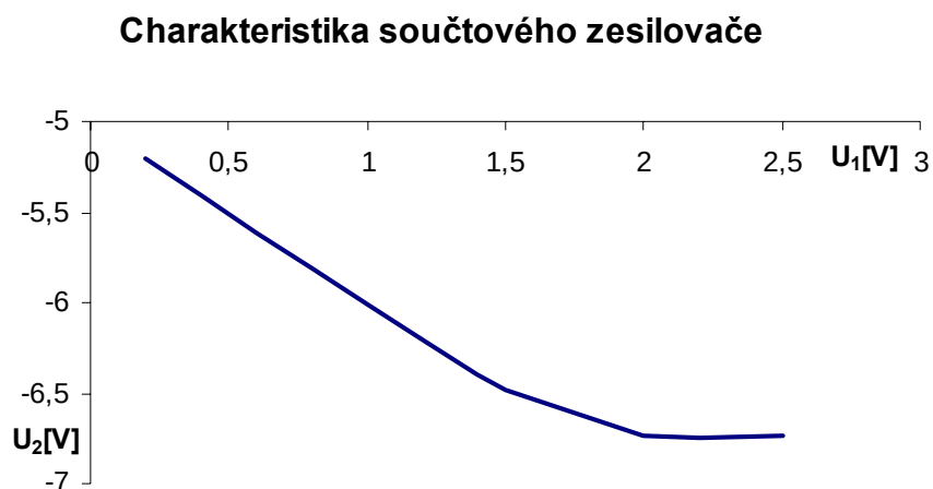
Graf č.3: Charakteristika invertujícího součtového zesilovače
