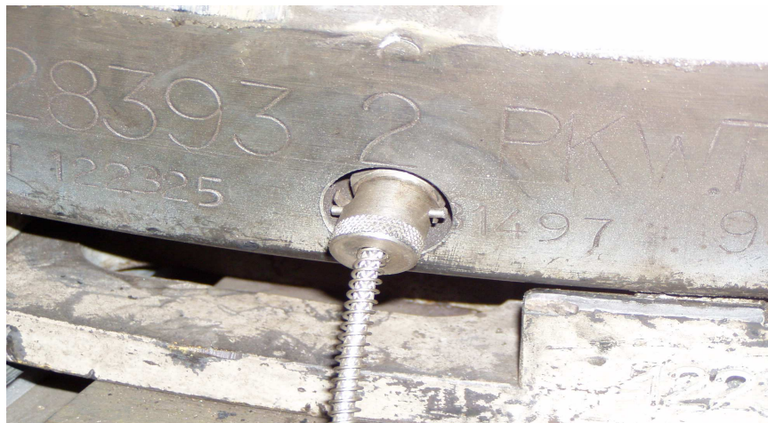
Obr. 23. Snímač upevněný k segmentu formy
