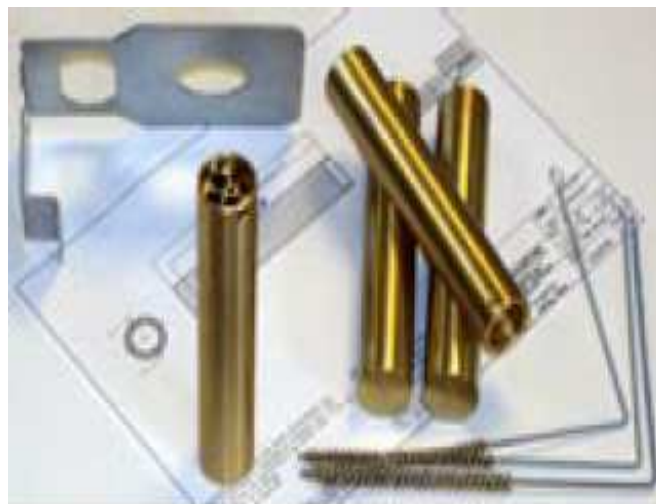
Obr. 6. Patrona do nichž se vkládá snímač
