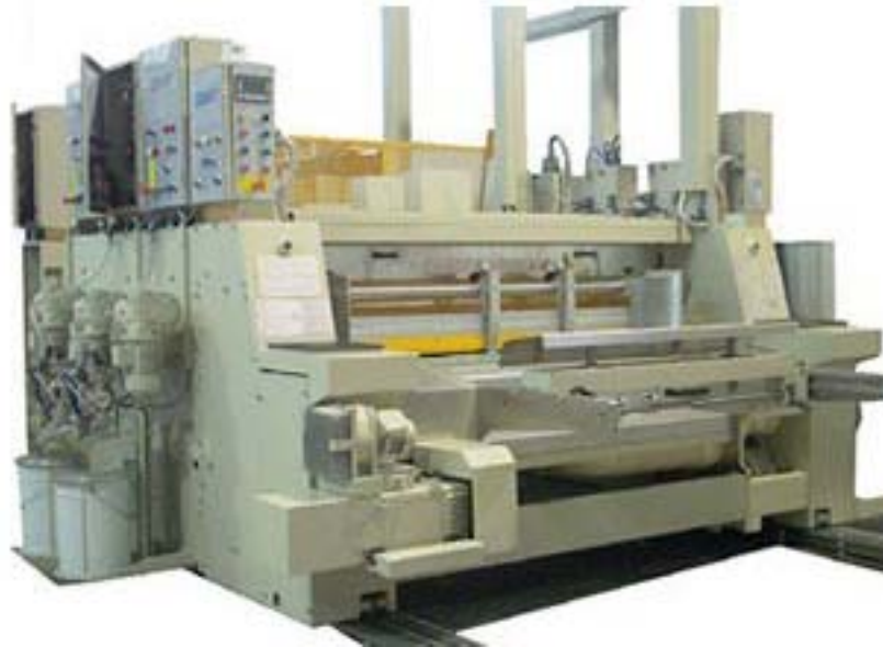
Obr. 9. Dvě flexo tiskové jednotky stroje in-line Curioni T série [2]
