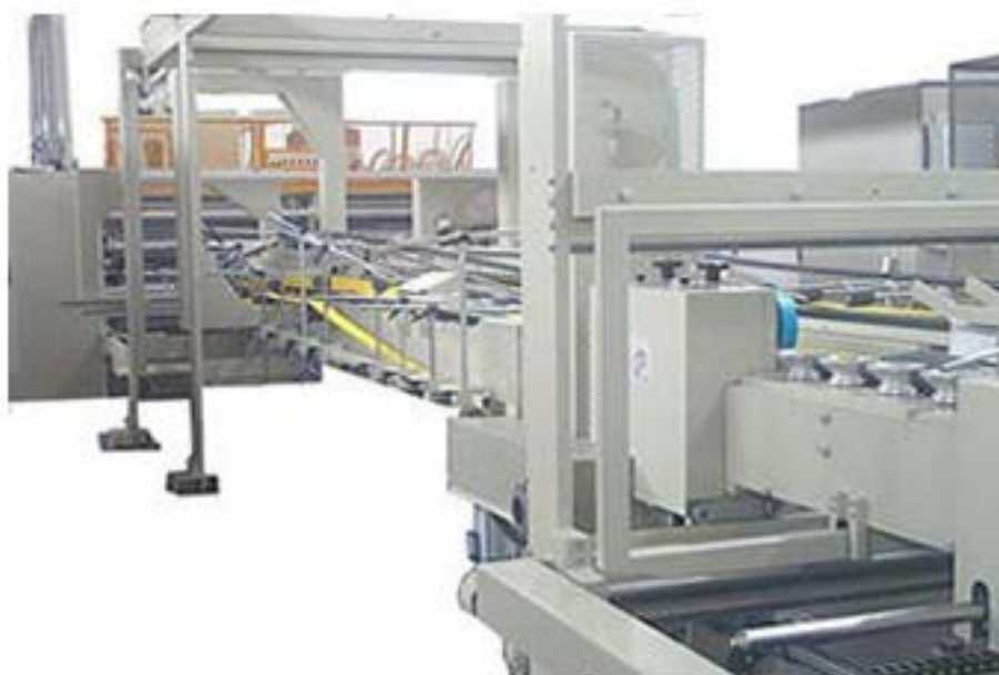
Obr. 11. Skládací a lepicí jednotka stroje in-line Curioni [2]
