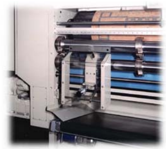
Obr. 10. Rotující vysekávací jednotka [2]
