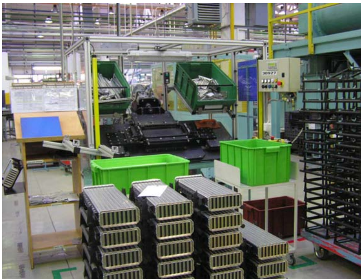
Obr. 21. Pracoviště skládání mezichladičů.
