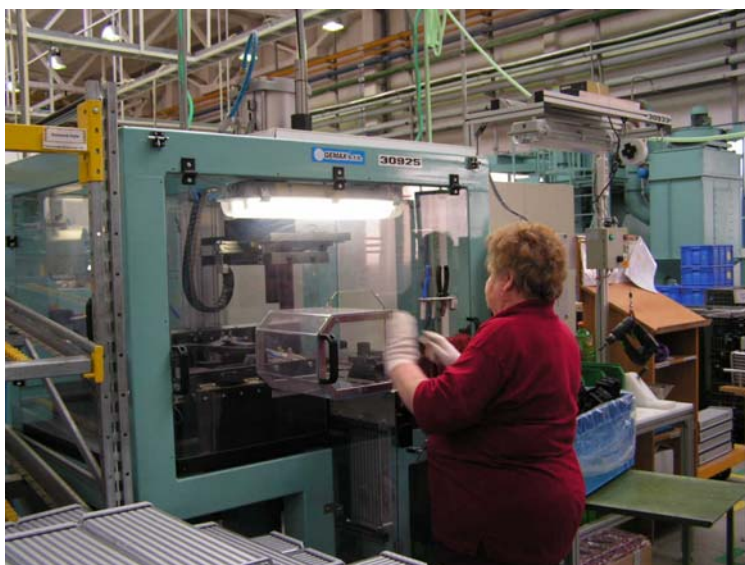
Obr. 23. Lemování komor. [Zdroj: vlastní zpracování]
