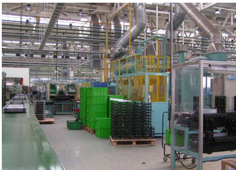
Obr. 12. Pohled na uspořádání pracoviště "skládání mezichladiče" před zavedením programu 5 S. [Zdroj: vlastní zpracování]
