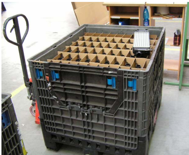
Obr. 26. Vkládání hotových mezichladičů na paletu.
