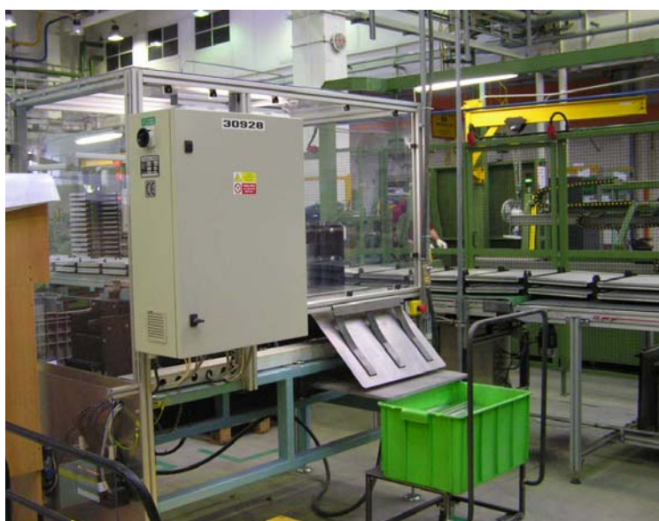
Obr. 20. Pracoviště vkládání vlnovců do trubky – pohled zezadu.
