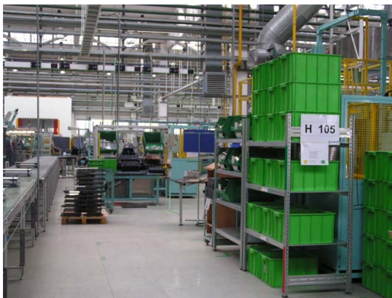
Obr. 13. Pohled na pracoviště "skládání mezichladiče" po zavedení programu 5 S. [Zdroj: vlastní zpracování].
