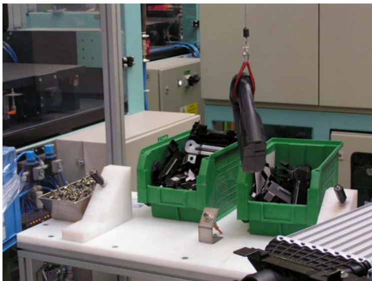
Obr. 24. Pracoviště "montáž držáků".
