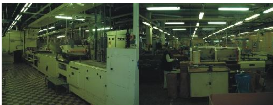
Obr. 8. Linka Carle & Montanari a balicí stroje linky Winkler & Dünnebier
