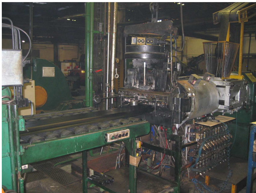
Obr. 15. Vytlačovací linka TROESTER
