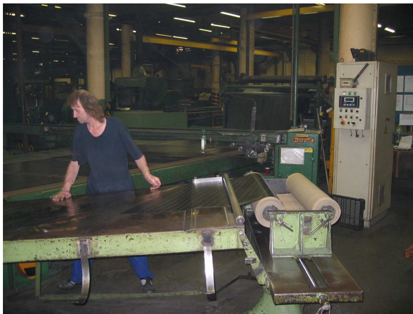
Obr. 16. Řezání kordu – řezací linka
