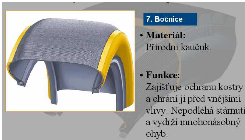
Obr. 11. Bočnice [16]
