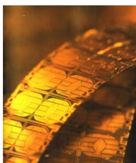
Obr. č.14 - Výroba mikromodulů (čipů do platebních karet)
