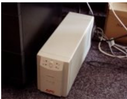
Obr. 10: Nasazení záložního zdroje APC
