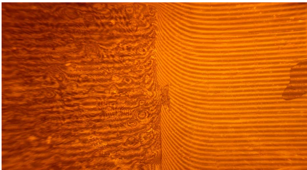
Obr. 21:Fotografický záznam hrúbky PNV pre CMC – 7H4FX v čase 60s
