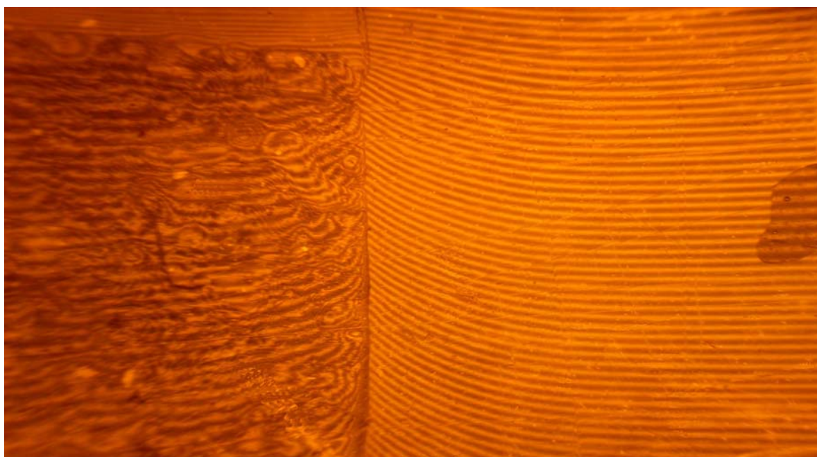
Obr. 27: Fotografický záznam hrúbky PNV pre CMC – 7H4FX v čase 299s
