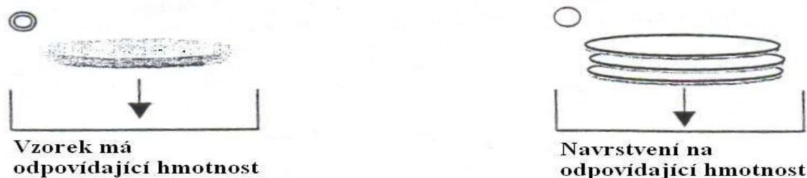
Obr.5. příprava vzorku ve formě filmu
