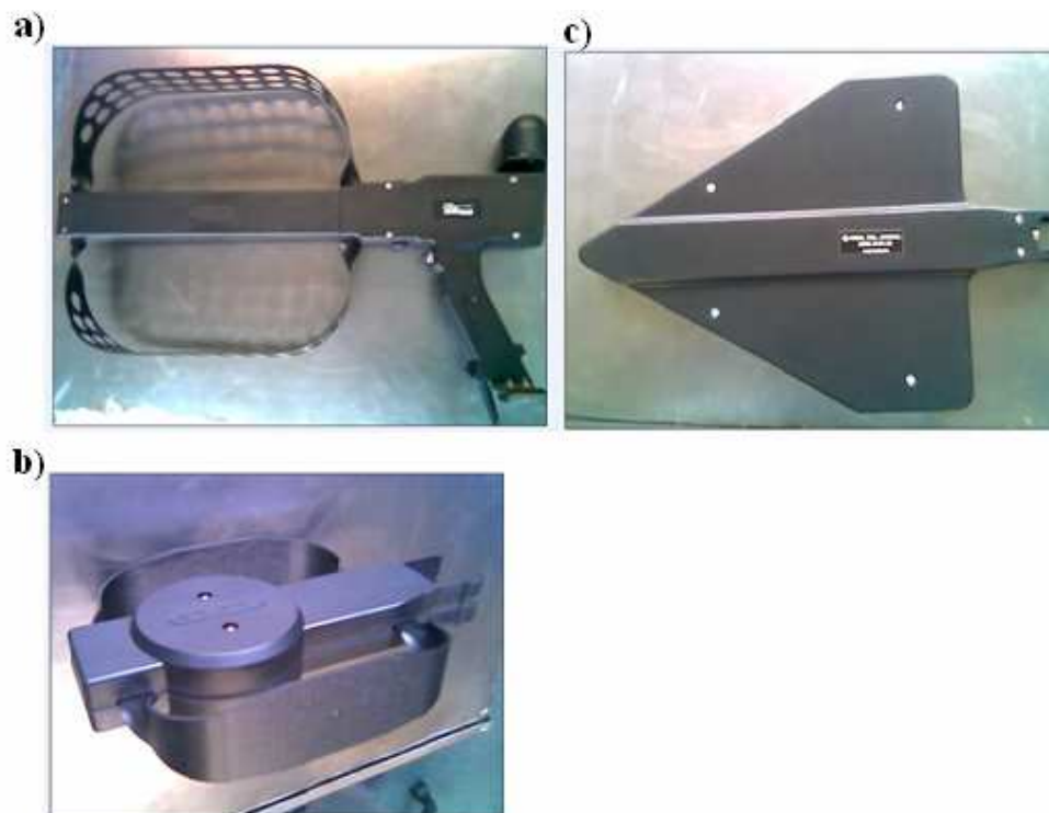
Obr. 25. Smerová anténa HE 200 s rozsahmi: a) 20 – 200 MHz; b) 200 – 500MHz; c) 500 – 3000 MHz.
