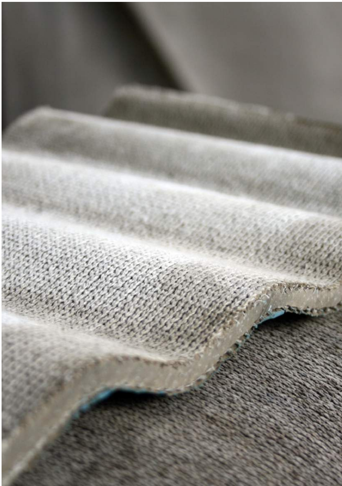
Príloha č.10. Betonové plátno
