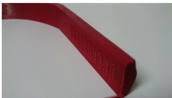
Obr. 68 Zoubky hlavového mostu
