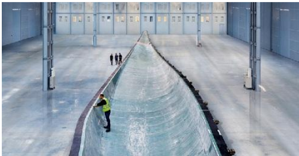
Obrázek 15-Výroba lopatky větrné elektrárny Siemens o výkonu 6 MW. [24]
