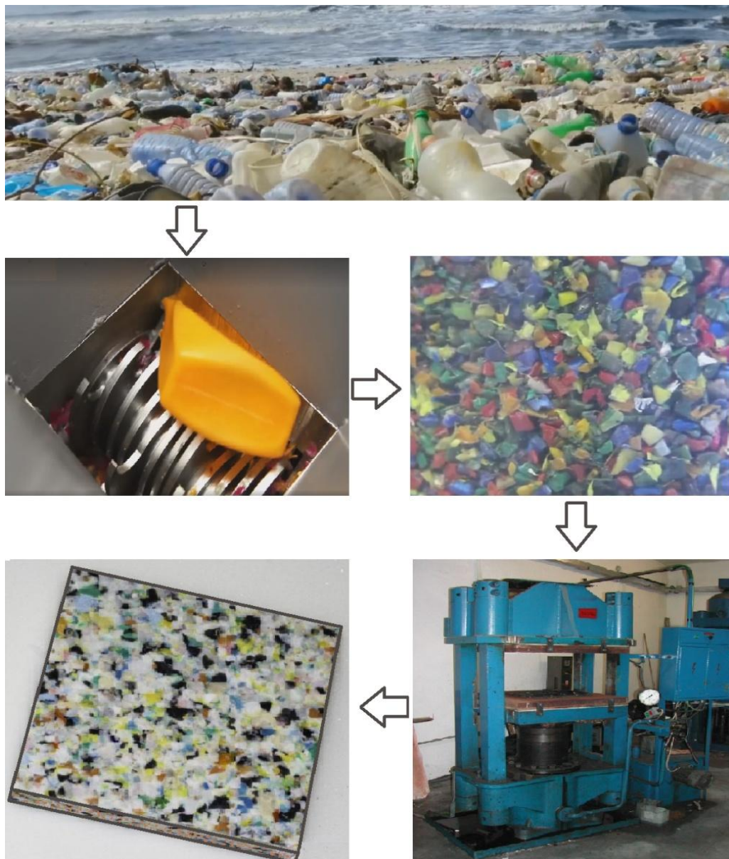
Obrázek 67-Způsob recyklace plastového odpadu na kompozitní desku.
