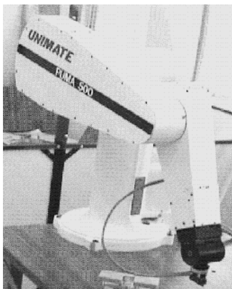
Obr. 1 První průmyslový robot – Unimate[1]
