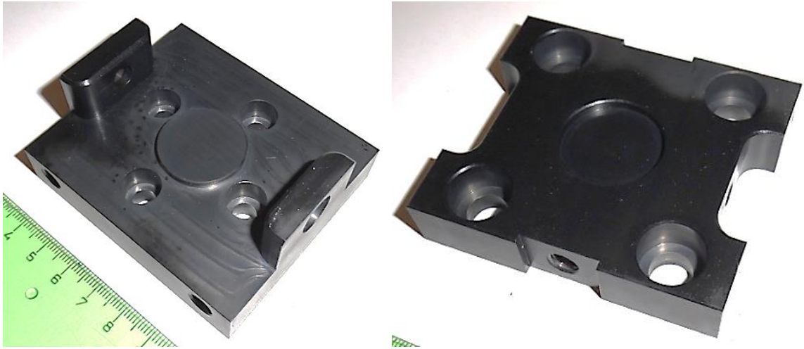
Obr. 64 Příruby - vlevo pro uchycení k robotu, vpravo pro uchycení pístu
