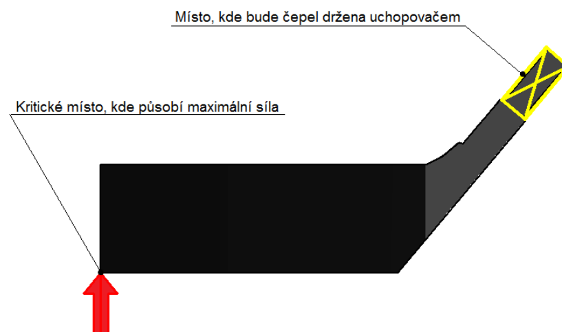
Obr. 40 Znáornění působení síly v nejkritičtějších místě
