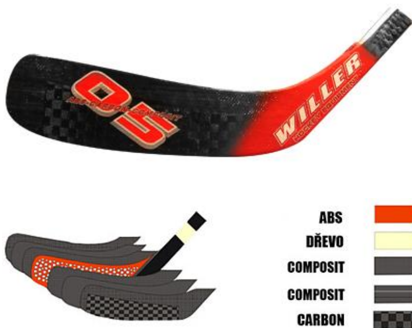
Obr. 29 Hokejová čepel a její složení od firmy WILLER
